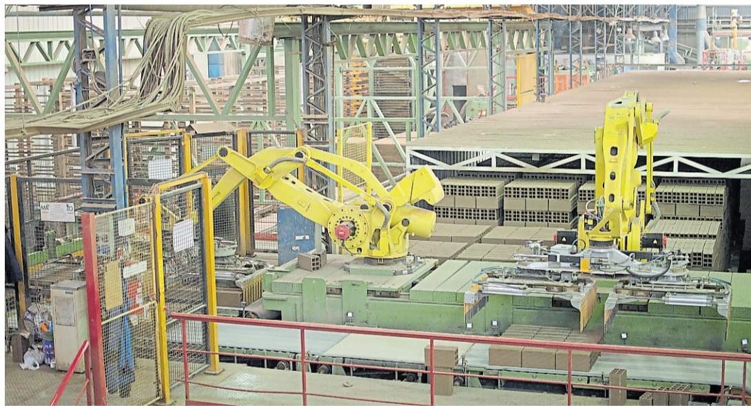
PLANTAS ROBOTIZADAS. La fabricación de ladrillos cerámicos huecos suma eficiencia.
